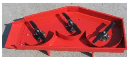
Nr.3 lame, diam.400 spessore 6,5, ad alta ventilazione –velocità tangenziale 94 m/s
