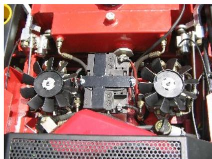
Doppia pompa idrostatica – una pompa per ogni ruota muove un motore a trasmissione diretta
