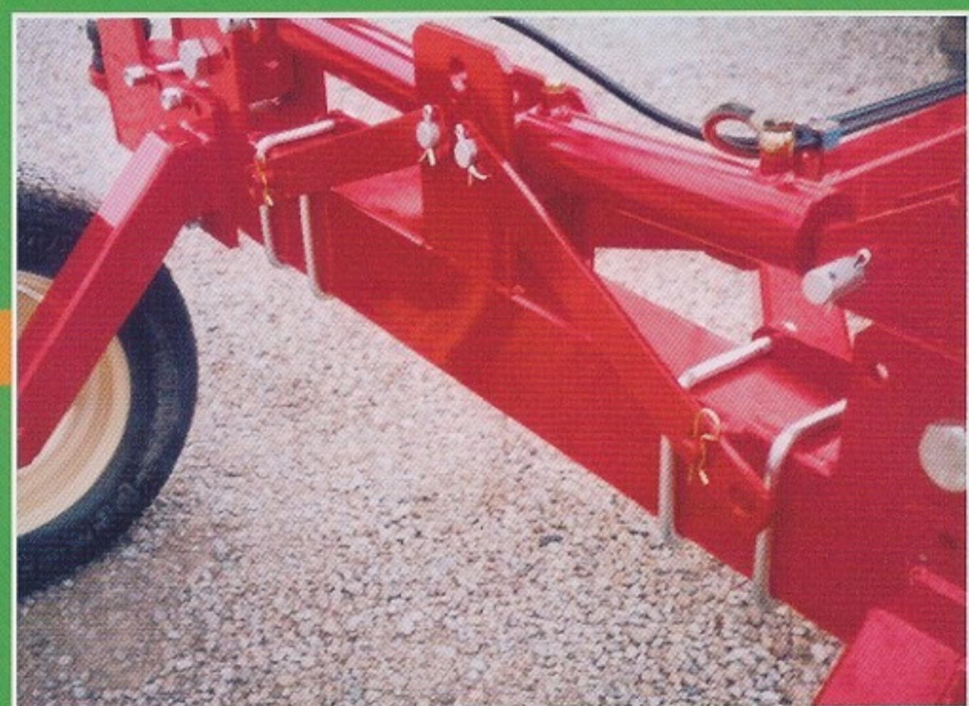
Apparecchio di sicurezza disinserto in posizione di lavoro
